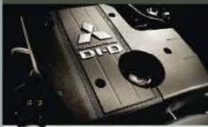
Motorização versátil com tecnologia de motor flex 3.5 L de 205 cv<sup>(1)</sup> ou motor diesel turbo Intercooler Common-Rail DI-D 3.2 L com 165 cv.
